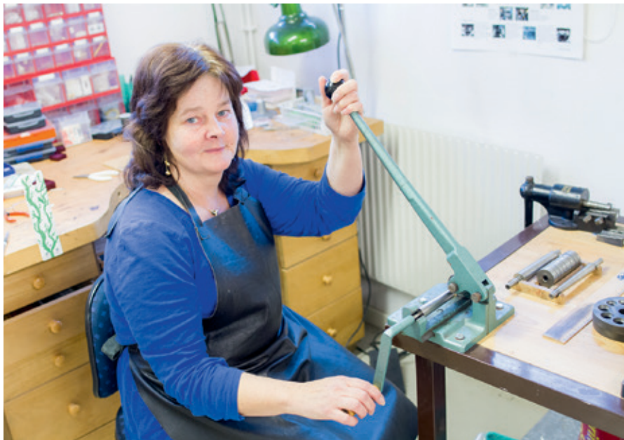
Lena i sin verkstad vid sin ringvals, som används för att göra ringar större.
