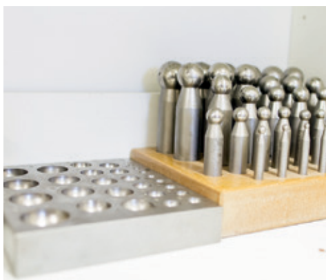
En så kallad puckelanka används för att forma guld eller silver till skålform eller till kulor.
