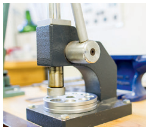
Ringhalsen används för att förminska ringars storlek.
